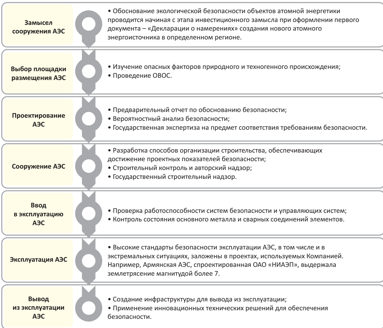
Рис. 59. Обеспечение безопасности на всех этапах жизненного цикла АЭС
