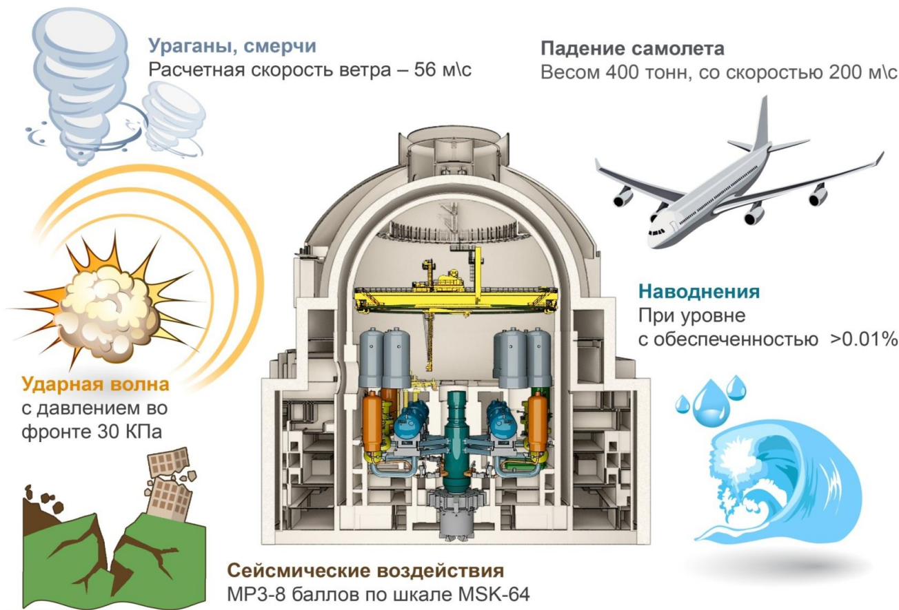
Схема внешних воздействий на энергоблок АЭС
